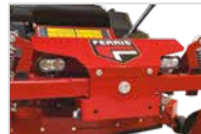
LED tuled - esipaigaldus 2x6 W esipaigaldusega energiatõhusad LED tuled.
