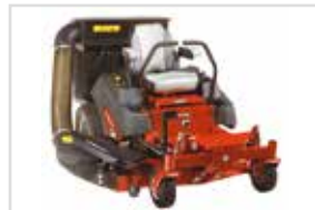
Turbo-Pro™ kogumissüsteem 227 liitri mahutavusega kõva kaanega õhktranspordiga kogumissüsteem.
